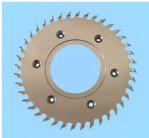
Truciolatore compatto in diamante riaffilabile con lama integrata, adatto per lavorazioni di pannelli truciolari nobilitati, laminati, M.D.F., etc., dove è necessario diminuire l'impatto tra materiale e utensile, utilizzabile su macchine squadratrici e squadrabordatrici.
