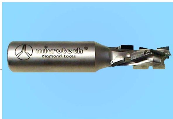
Punta in diamante ad elica interrotta, tipo economico, tre divisioni, fora/contorna, adatta per lavorazioni di pannelli truciolari nobilitati, laminati, M.D.F., etc., dove è necessario lavorare con piccoli diametri ed elevate velocità di avanzamento, utilizzabile su macchine automatiche e CNC.
