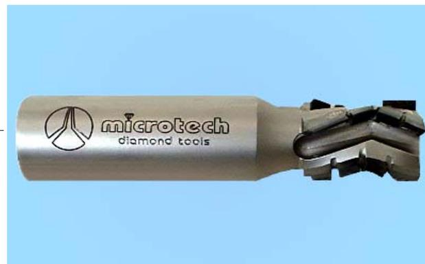
Punta in diamante riaffilabile ad elica continua, quattro divisioni, negativa/positiva, fora/contorna, adatta per lavorazioni di pannelli truciolari nobilitati, laminati, M.D.F., etc., utilizzabile su macchine CNC, per elevatissime velocità di avanzamento.
