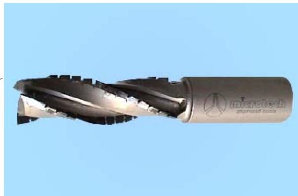
Punta in diamante riaffilabile ad elica continua, tre divisioni, fora/contorna, positiva, adatta per lavorazioni di legni duri, resine, etc., dove non è necessaria la finitura nella parte superiore, ma è importante lo scarico del truciolo, utilizzabile su macchine automatiche e CNC.
