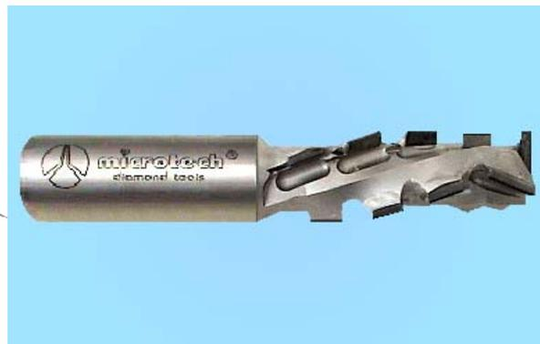
Punta in diamante riaffilabile ad elica interrotta, tre divisioni, negativa/positiva, fora/contorna, adatta per lavorazioni di pannelli truciolari nobilitati, laminati, M.D.F., etc., su macchine automatiche e CNC, per elevate velocità di avanzamento.
