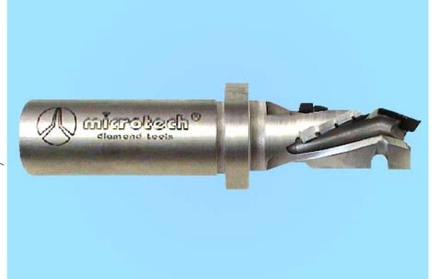
Punta in diamante riaffilabile, ad elica continua, tre divisioni, negativa positiva, fora/contorna, adatta per lavorazioni di pannelli truciolari nobilitati, laminati, M.D.F., etc., utilizzabile su macchine automatiche e CNC, per elevate velocità di avanzamento.
