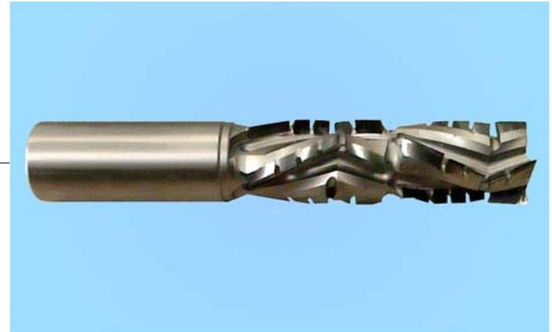
Punta in diamante riaffilabile ad elica continua, quattro divisioni, negativa positiva, doppia rotazione DX/SX, adatta per lavorazioni di pannelli truciolari nobilitati, laminati, M.D.F., etc. utilizzabile su macchine automatiche e CNC, per elevate velocità di avanzamento.
