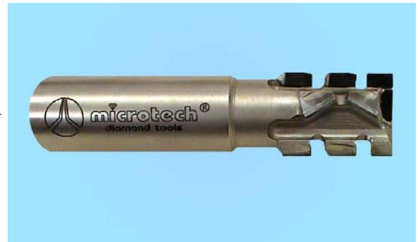
Punta in diamante riaffilabile dritta, quattro divisioni, negativa/positiva, fora/contorna, con taglienti interrotti, molto assiali, adatti per lavorazioni di pannelli truciolari nobilitati, laminati, M.D.F., legni duri, etc., utilizzabile su macchine automatiche e CNC, per elevate velocità di avanzamento.
