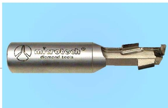
Punta in diamante tipo usa e getta, tre divisioni, negativa/positiva, fora/contorna, adatta per lavorazioni di pannelli truciolari nobilitati, laminati, rivestiti, M.D.F., etc., utilizzabile su macchine manuali, automatiche e CNC.
