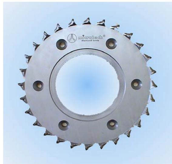
Truciolatore compatto a profilo raggiato riaffilabile, ad alto rendimento, adatto per lavorazioni di pannelli truciolari nobilitati, laminati, rivestiti, M.D.F., etc., utilizzabile su macchine squadratrici e squadrabordatrici a doppio truciolatore per elevate velocità di avanzamento.
